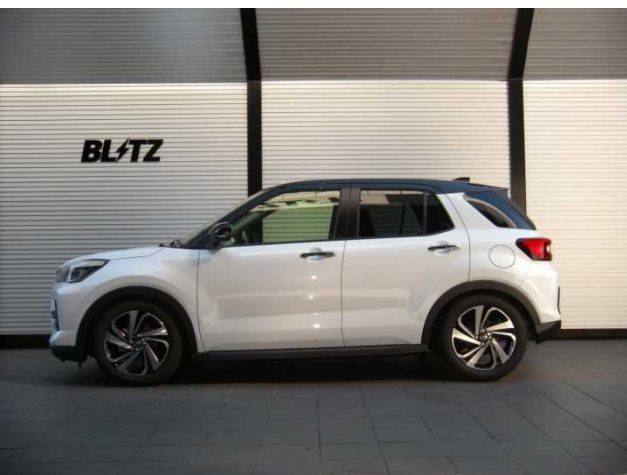
フロント:-52mm ダウン / リア:-54mm ダウン
