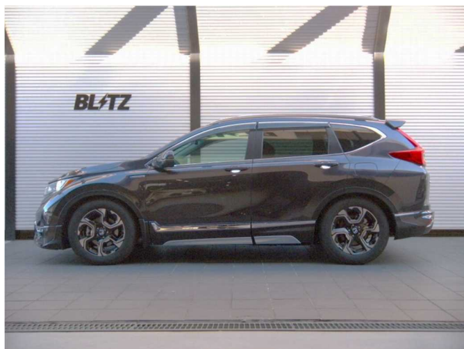
フロント:-40mm ダウン / リア:-38mm ダウン
