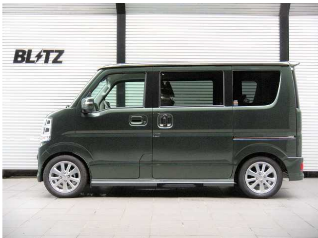
フロント:-35mm ダウン / リア:-46mm ダウン
