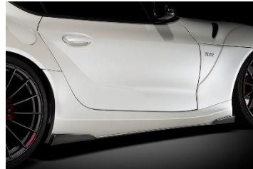
サイドスポイラー (FRP) & サイドディフューザーカーボン
