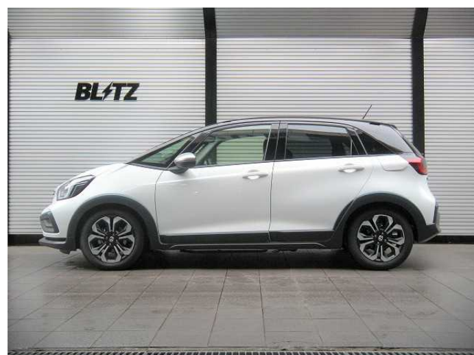
フロント:-27mm ダウン / リア:-43mm ダウン
