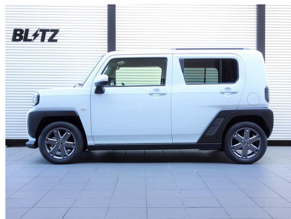
フロント:-11mm ダウン / リア:-31mm ダウン
