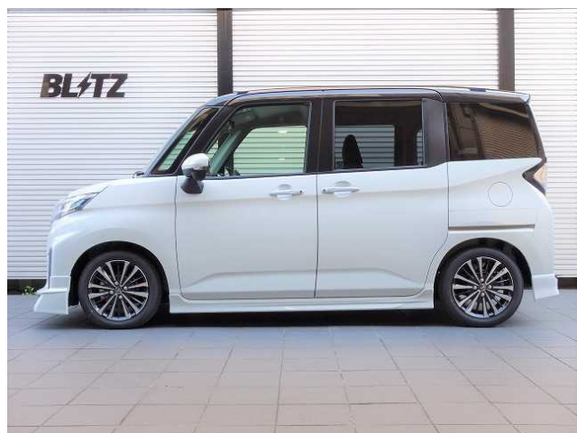
フロント:-27mm ダウン / リア:-32mm ダウン
