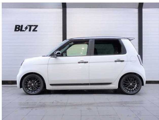
フロント:-36mm ダウン / リア:-39mm ダウン
