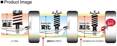
車高ダウンによってロアアームの 位置も下がり、ロールセンターも 下がります。 ラテラルリンクの位置を適正化します。 (ロールセンターを上げる)
