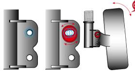
偏心カムを採用した車種別ブ ラケットの穴形状とそれに合 わせた専用のボルトを容易に 動かせるため、簡単且つワイ ドレンジでキャンバー調整が 可能になります。ブラケット部 分で 0 度~-5 度まで調整可 能となります。
