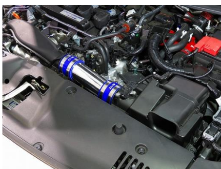
ホンダ シビックハッチバック FK7用 SUCTION KIT BLUE 装着写真
