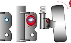
偏心カムを採用した車種別ブ ラケットの穴形状とそれに合 わせた専用のボルトを容易に 動かせるため、簡単且つワイ ドレンジでキャンバー調整が 可能になります。ブラケット部 分で 0 度~5 度まで調整可 能となります。
