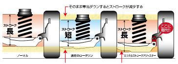
車高ダウンによってロアアームの 位置も下がり、ロールセンターも 下がります。 ラテラルリンクの位置を適正化する (ロールセンターを上げる) とともに ストローク量も確保します。
