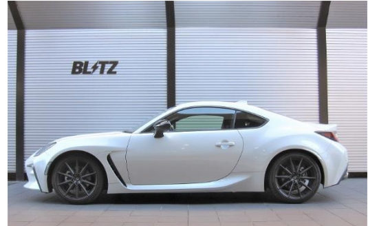
フロント：-23mmダウン / リア：-28mmダウン
