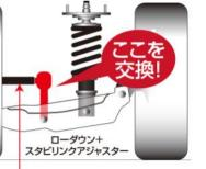
車高が下がった分、スタビライザー取り付け位置・角度が変化し、 純正スタビライザーリンクの場合、適正ではない位置で取り付けしなくてはなりません。 調整式のスタビリンクアジャスターに交換することで、 ローダウン状態でも適正な位置でスタビライザーを接続できます。 さらに、接続部をビロボール化することで、ダイレクトな動作を実現します。
