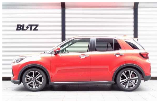
フロント：-45mmダウン / リア：-57mmダウン
