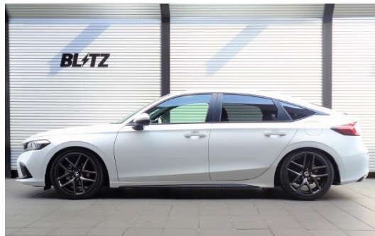
フロント：-29mmダウン / リア：-45mmダウン
