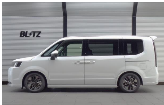
フロント：-42mmダウン / リア：-56mmダウン
