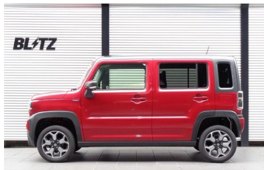
フロント：+31mm(1.2in)アップ / リア：+19mm(0.7in)アップ
