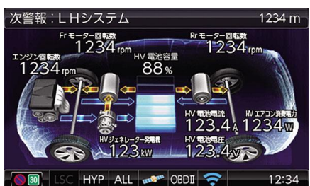
エネルギーモニター HV車の各種情報と エネルギーの流れを表示
