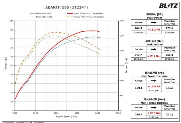
※SPORTモードで測定したパワーグラフです。 ※グラフ、データは弊社シャーシダイナモでの計測事例です。車両ならびに装着部品、燃料などにより個体差があります。
