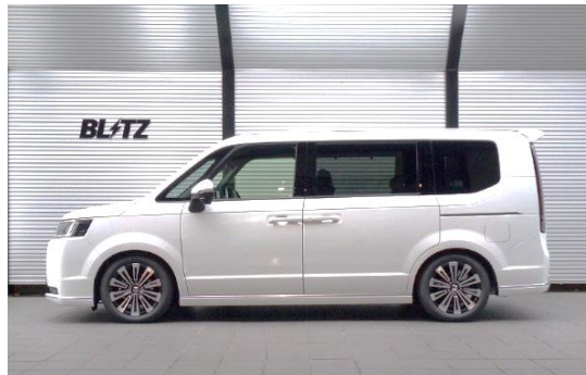
フロント：-29mmダウン / リア：-34mmダウン
