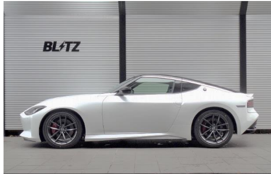
フロント：-22mmダウン / リア：-22mmダウン
