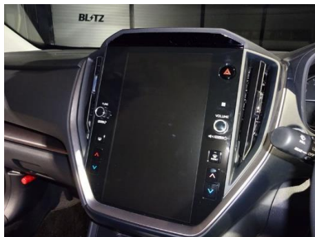
インプレッサ 11.6 インチセンター インフォメーションディスプレイ
