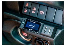
シエラも現在のクルマでは主流となる電子制御式スロットルを採用。20モードから好みのフィーリングを選べるスロコンは、発進時のものたつきやレスポンスの低下を改善。本体はVA方式液晶で視認性が良い。
