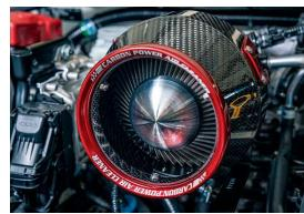
ステンレスメッシュフィルターのエアクリーナーに、周囲の放射熱を遮るシールドを装備。カーボンシールドは本体の発熱抑制にも効果あり。他にはアルミシールドタイプ、シールドなしタイプなどを設定する。
