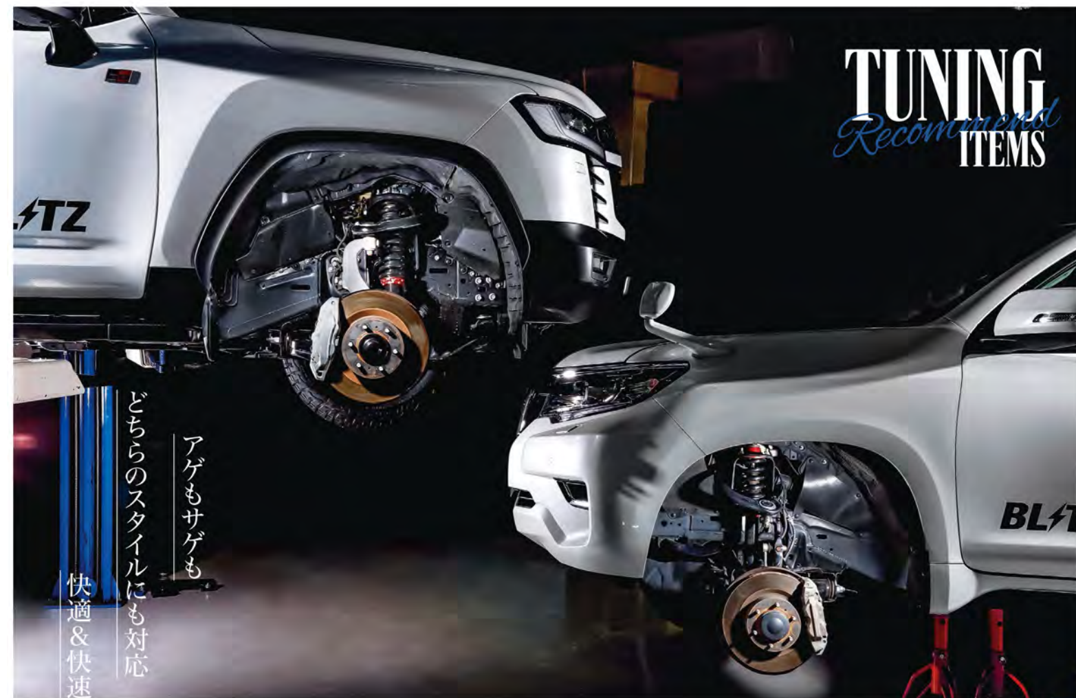
耐久性に優れた特殊高張力材を使用したオリジナルスプリング。プラド用のパネレートは①18.0kg/mm、②5.0kg/mm。ランクル300用は①10.0kg/mm、②4.5kg/mmとなる
