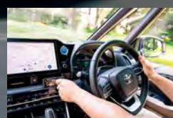
直感的な操作が可能なロータリーコマンダーを採用したコントロールユニット。乗車人数、走行状態から適切な減衰力を導き出すフルオートモードも搭載！ より使いやすくなった!!
