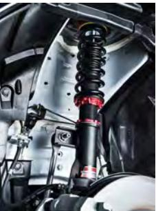
全長調整や減衰力調整機能、単筒式ダンパーなど欲しい装備をすべて盛り込んだダンパーZZ-R車高調。アリア用ではEVならではの車重やパワー特性を吟味して専用チューニングされる。
