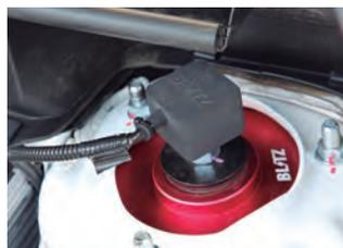
DSC PLUSはダンパーのトップにある減衰力調整用のダイヤルをステッピングモーターで回転させている。前後独立した減衰設定も可能
