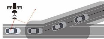
ジャイロセンサー搭載により、GPSが受信できないトンネル内や高架下などでも警報します。
