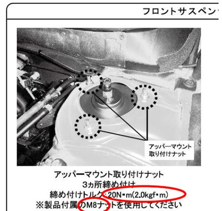
※該当の部分は、フロントアッパーマウントの3カ所になります。キット付属のM8ナットを使用いただき、規定トルク：20N・m（2.0kgf・m）で、締め付け確認をお願い致します。
