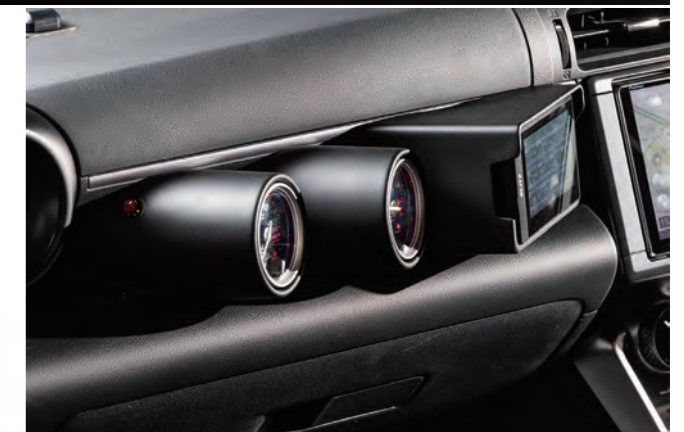
「RACING METER PANEL」のBRAIN+2連 METER PANEL単体モデル。カラーはマットブラックのみで、取り付け用ビスが付属。価格は3万3000円。運転席から見やすい角度にオフセットしているので、視認性は抜群
