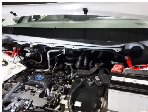
ノアハイブリッド フロント用 装着写真 (ワイパーカウルを取り外した状態)
