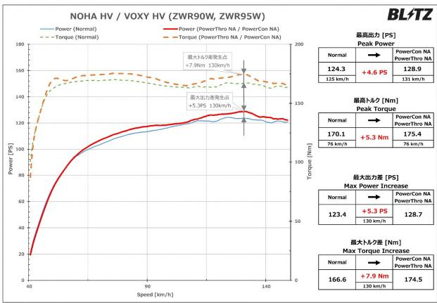
※グラフ、データは弊社シャーシダイナモでの計測事例です。車両ならびに装着部品、燃料などにより個体差があります。 ※E-Four(電気式4WD)車は2WDモードで計測しています。
