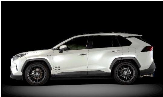
フロント：45mmダウン / リア：50mmダウン
