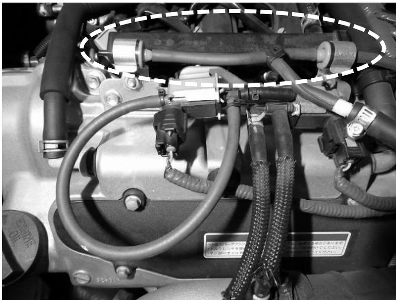
(2) ブローオフバルブ本体に繋がるキット付属のゴムホースφ6と純正のホースをφ4ーφ6ストレートジョイントを使用して接続して下さい。純正ホースはタイラップ100mmを使用して固定して下さい。その他の作業内容は取付説明書通りとなります。作業内容は以上です。
