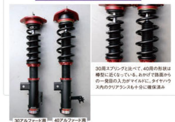
30用スプリングと比べて、40用の形状は樽型に近くなっている。おかげで路面からの一発目の入力がマイルドに。タイヤハウス内のクリアランスも十分に確保済み
