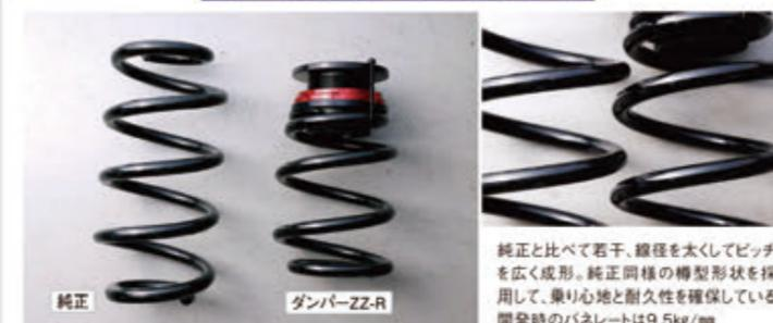
純正と比べて若干、線径を太くしてピッチを広く成形。純正同様の樽型形状を採用して、乗り心地と耐久性を確保している。開発時のパネレートは9.5kg/mm
