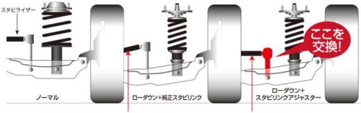
車高が下がった分、スタビライザー取り付け位置・角度が変化し、 純正スタビライザーリンクの場合、適正ではない位置で取り付けしなくてはなりません。 調整式のスタビリンクアジャスターに交換することで、 ローダウン状態でも適正な位置でスタビライザーを接続できます。 さらに、接続部をビロボール化することで、ダイレクトな動作を実現します。
