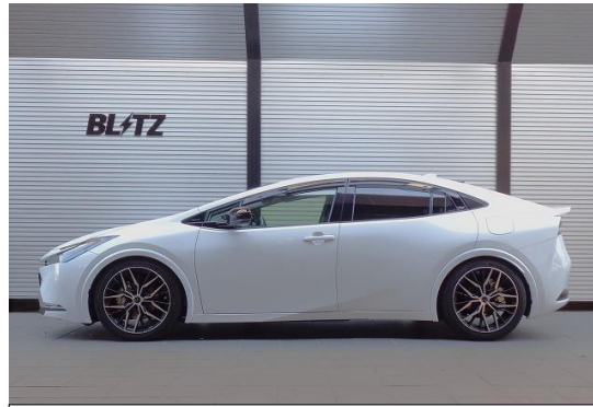
フロント：28mmダウン / リア：22mmダウン
