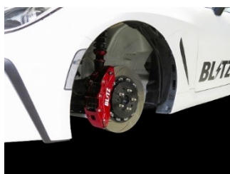
TOYOTA GR86 ZN8 Front 6POT・Rear 4POT 装着写真
