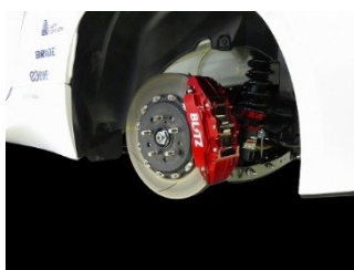
TOYOTA GR86 ZN8 Front 6POT・Rear 4POT 装着写真
