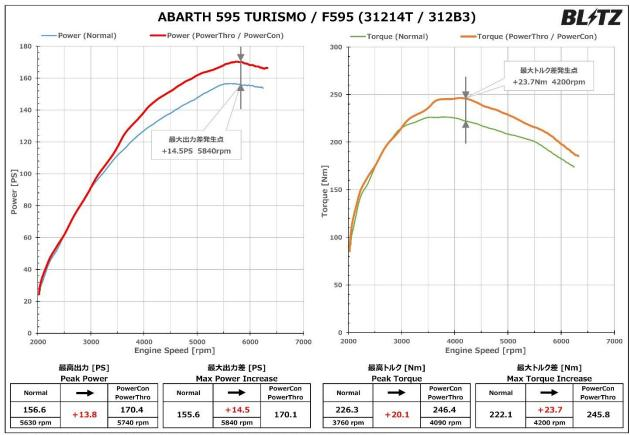
レーンングラフ、データは弊社シャーシダイナモでの計測事例です。車両の個体差や天候、装着部品、燃料など違いにより計測結果が異なる場合があります。 ※計測はSPORTモードで行っています。
