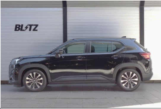
フロント : 37mmダウン / リア : 47mmダウン
