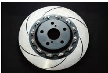
6本の曲線スリットが刻まれた355φローター。1ピースだが飾りボルトをあしらって、2ピース風に見せているのもポイントのひとつだ
