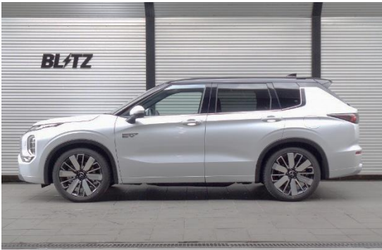
フロント：31mmダウン / リア：53mmダウン
